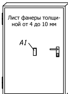
Рисунок 7 Защита деревянной пустотелой двери
